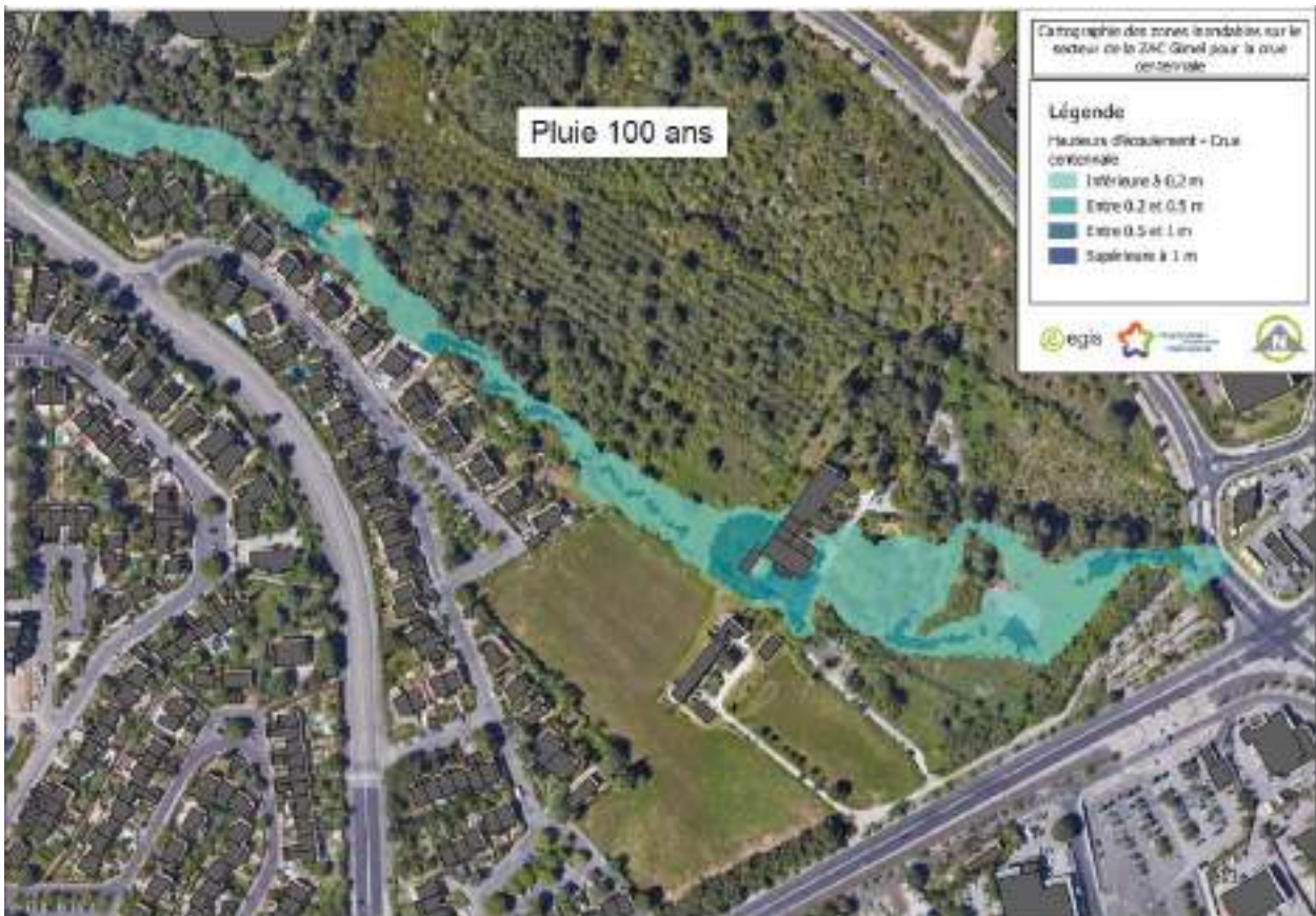
Figure 12 : Cartographie des zones inondable par ruissellement sur le secteur de Gimel pour une crue centennale
