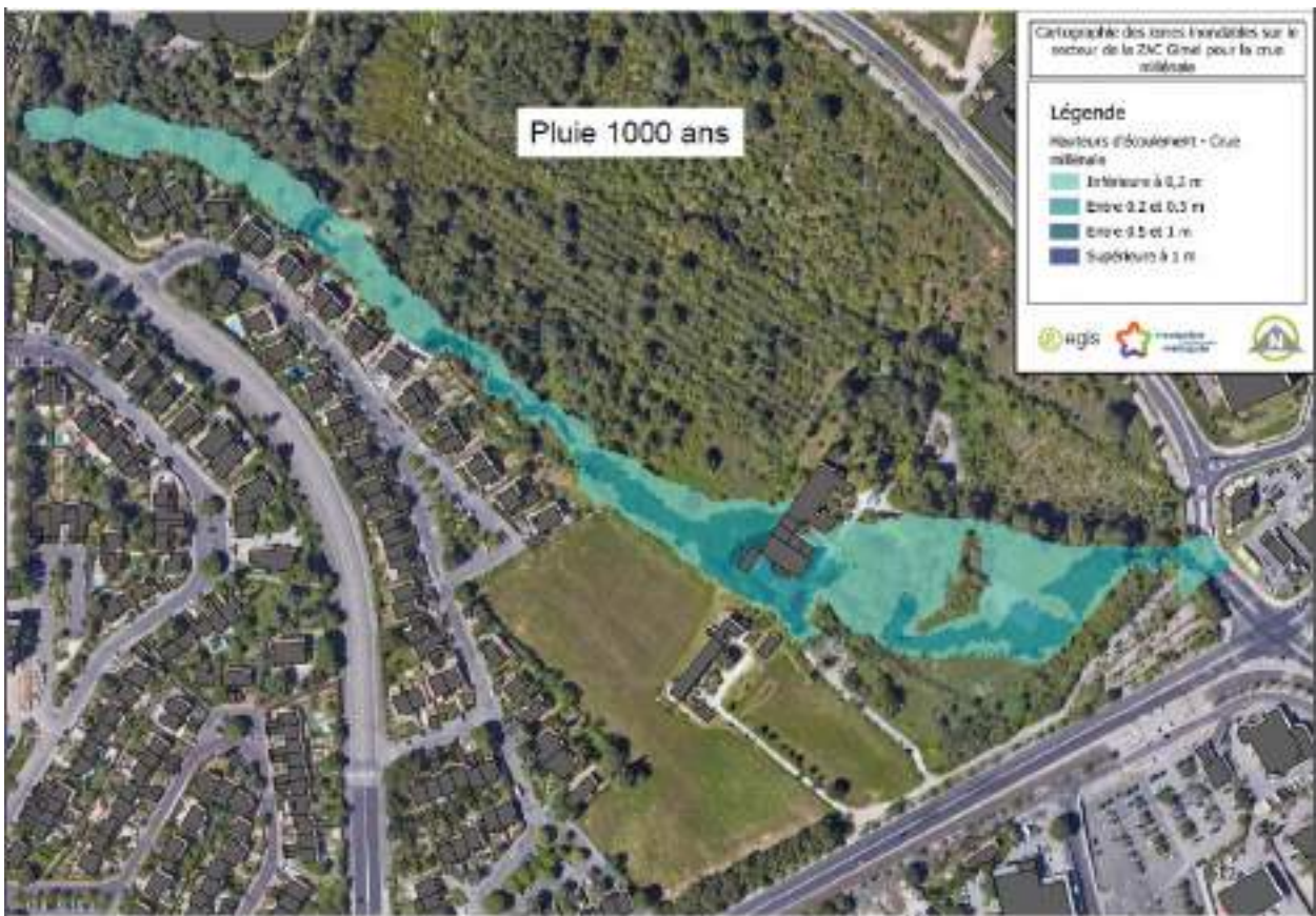
Figure 13 : Cartographie des zones inondable par ruissellement sur le secteur de Gimel pour une crue millénaire
