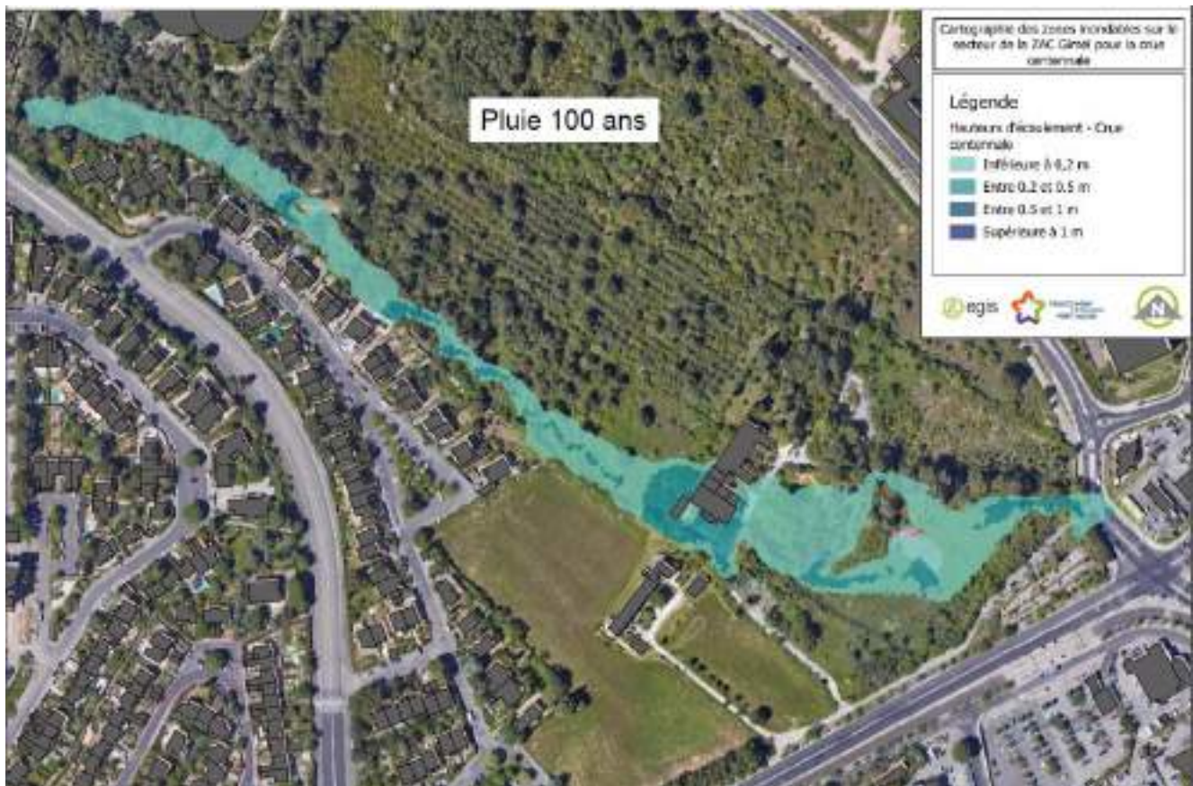
FIGURE 99 : CARTOGRAPHIE DES ZONES INONDABLE PAR RUISSellement SUR LE SECTEUR DE GIMEL POUR UNE CRUE CENTENNALE
