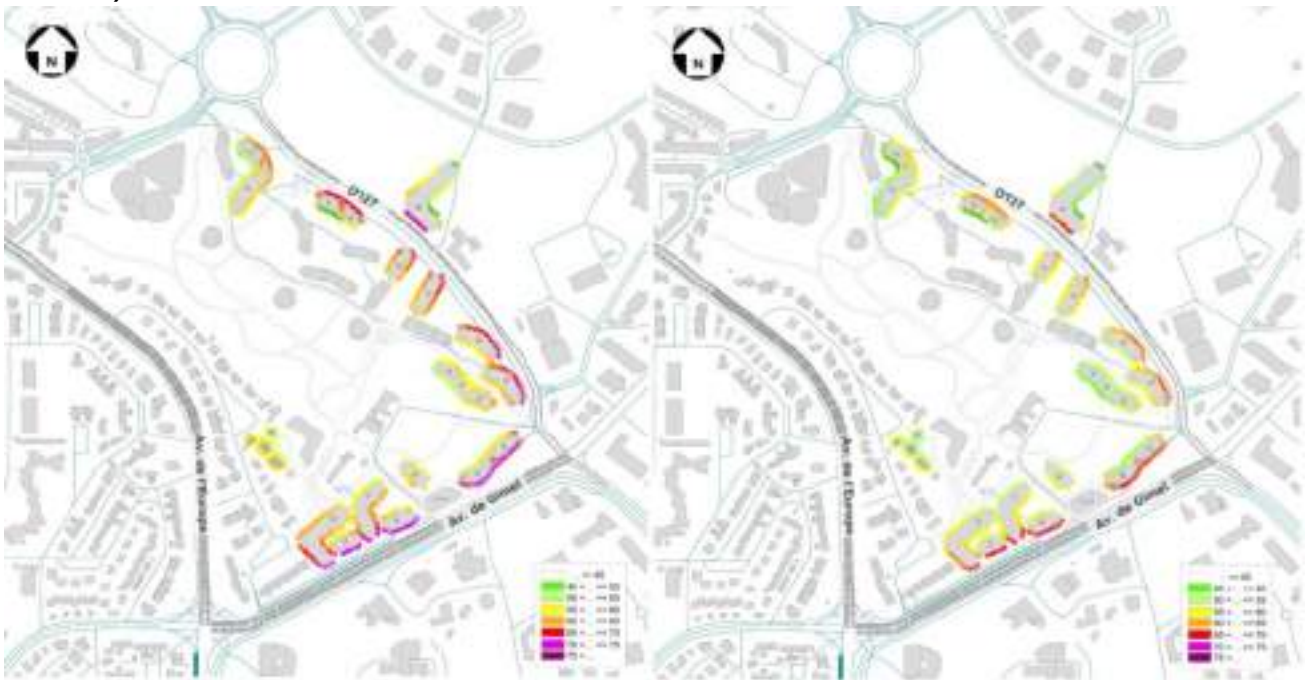
FIGURE 114 : NIVEAUX SONORES CALCULES EN FAÇADE DES BATIMENTS DU PROJET SITUES DANS LE SECTEUR AFFECTE PAR LE BRUIT DES INFRASTRUCTURES CLASSEES (PERIODE DIURNE A GAUCHE ET PERIODE NOCTURNE A DROITE)
