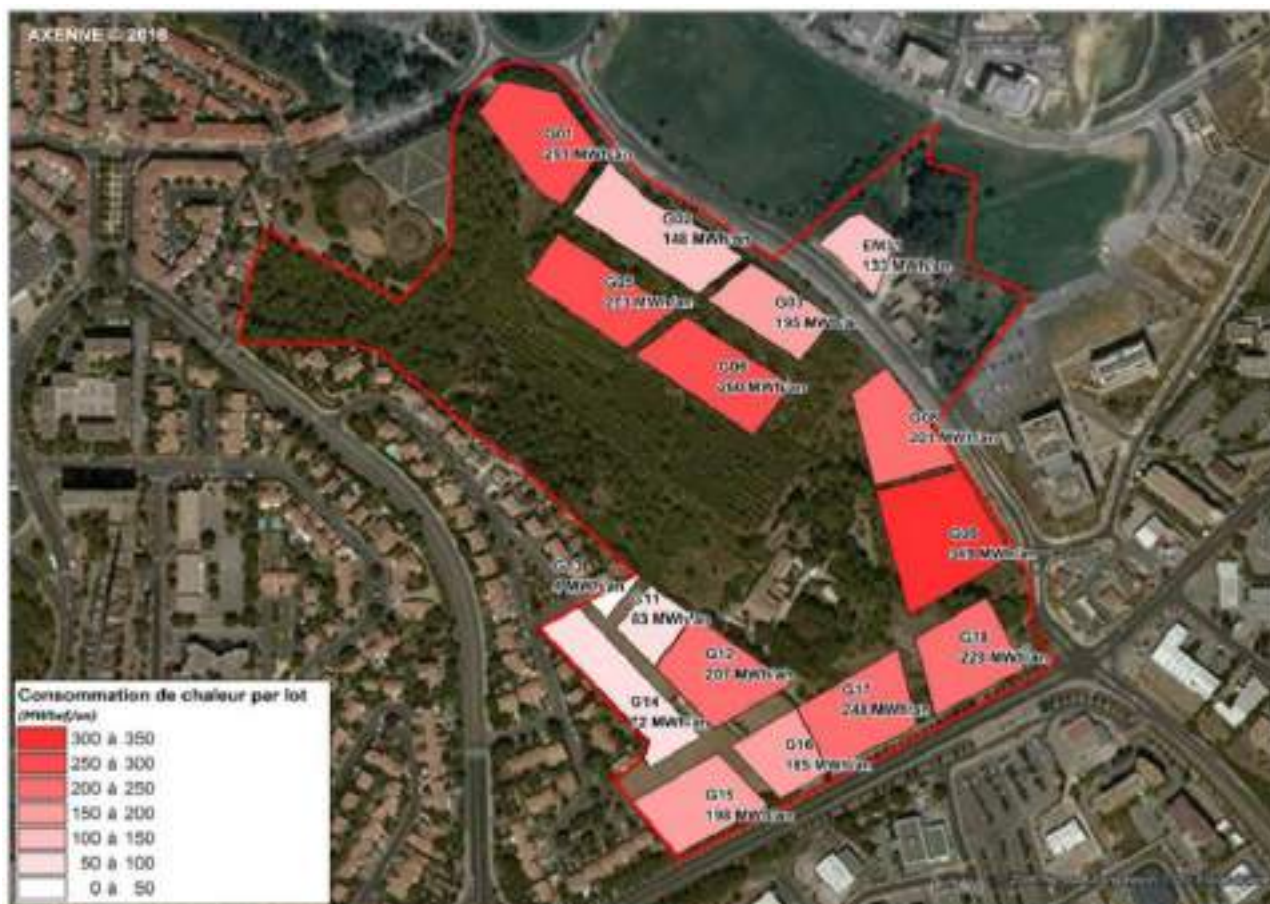
FIGURE 134 : CONSOMMATION D'ÉNERGIE FINALE POUR LE CHAUFFAGE DE TOUS LES BATIMENTS ET L'EAU CHAUDE SANITAIRE DES LOGEMENTS
