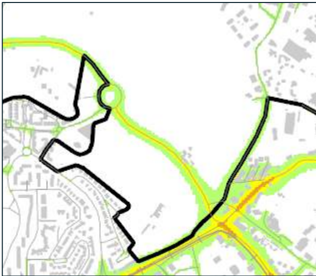
Carte de type A - situation 2005 – bruit routier indicateur de nuit : Ln (22h-6h)
