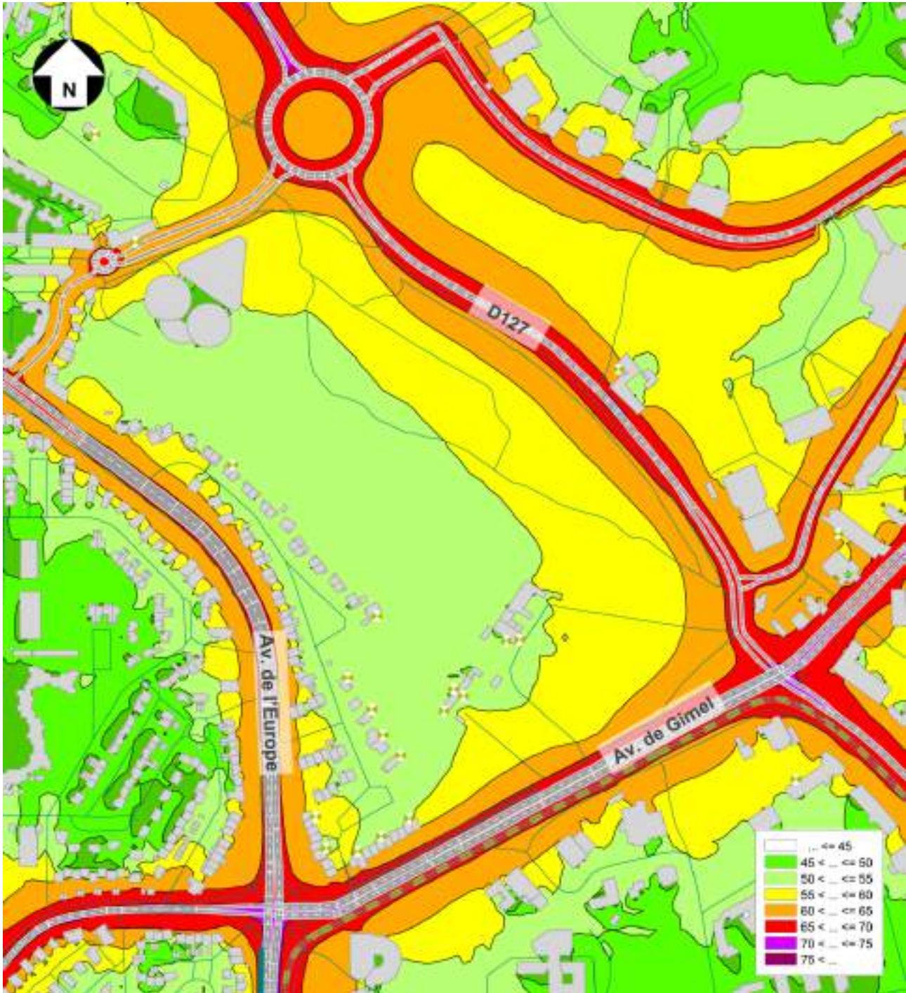
FIGURE 108 : CARTOGRAPHIE DES NIVEAUX SONORES – ÉTAT INITIAL - PERIODE DIURNE (6H - 22H) – H = 4M
