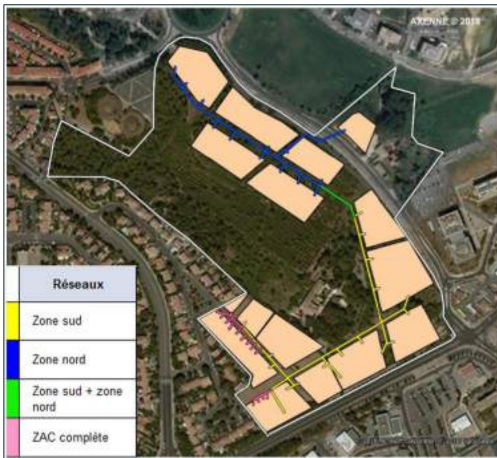
FIGURE 136 : TRACE ET EXTENSIONS DU RESEAU DE CHALEUR POTENTIEL DES BATIMENTS PAR LOT
