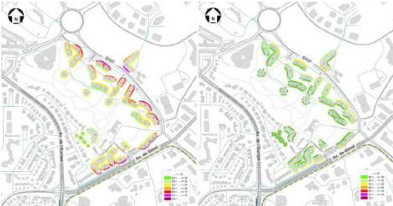
FIGURE 118 : NIVEAUX SONORES CALCULES EN FAÇADE DES BATIMENTS DU PROJET (PERIODE DIURNE A GAUCHE ET PERIODE NOCTURNE A DROITE)
